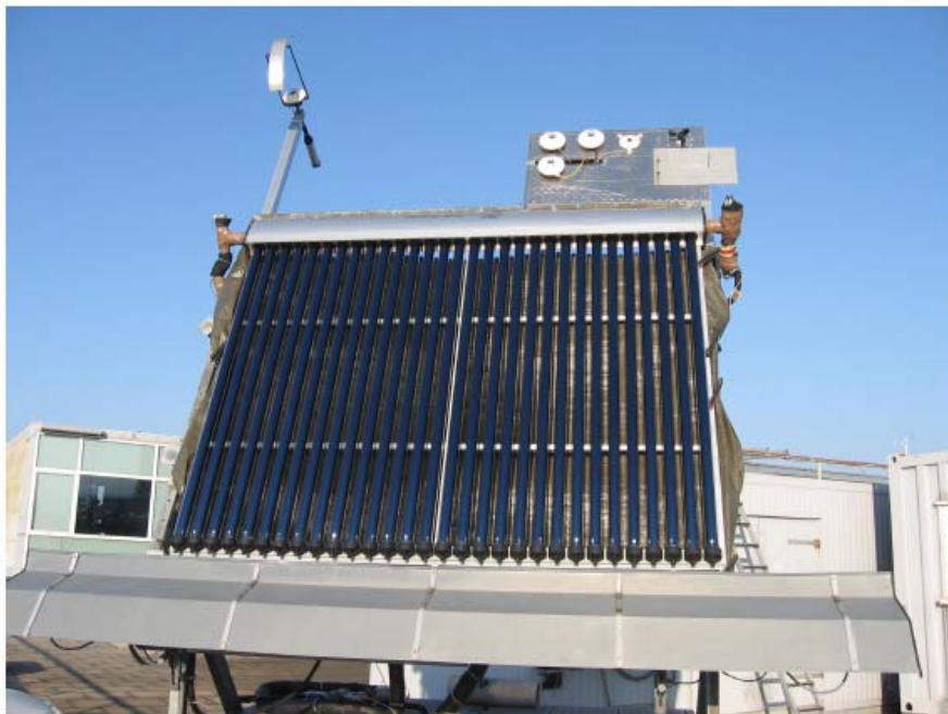
Colector TZ58/1800-30R montado en el banco de pruebas de Fraunhofer ISE
